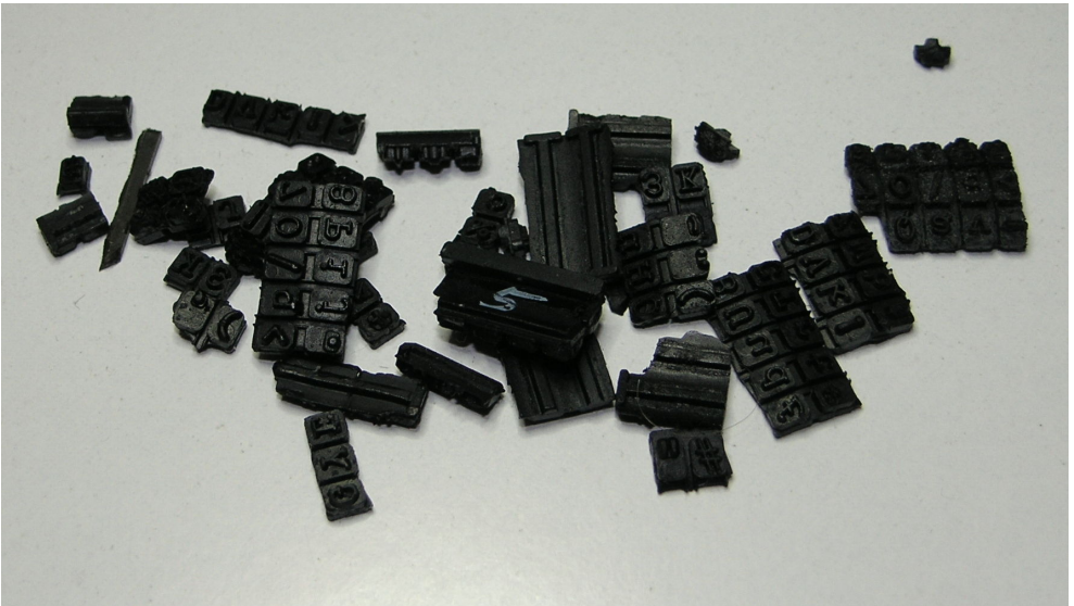
Typische Typenwalzenfragmente eines 1027 Druckers
