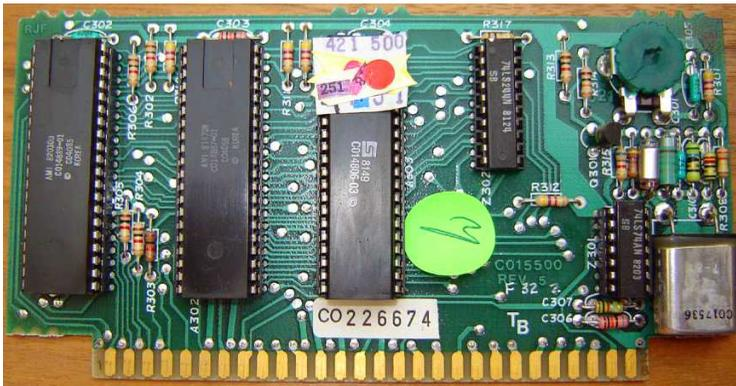
Abb. 4.12: Foto CPU-Board 800 (PAL) mit CPU 'SALLY'
